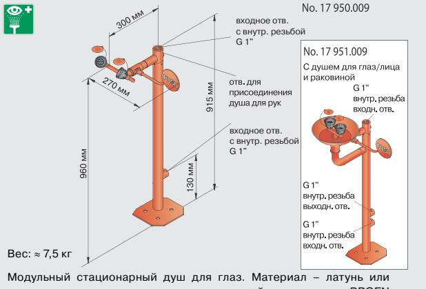
Модульный стационарный душ для глаз. Материал – латунь или нержавеющая сталь, покрытая химически стойким покрытием BROEN Polycoat. Поставляется со встроенным компонентом FLOWFIX (26 л/мин).
