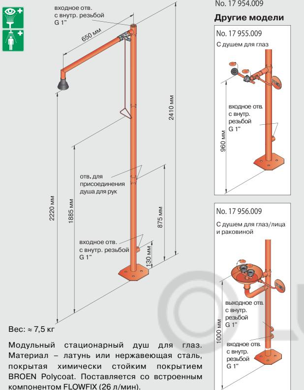
Модульный стационарный душ для глаз. Материал – латунь или нержавеющая сталь, покрытая химически стойким покрытием BROEN Polycoat. Поставляется со встроенным компонентом FLOWFIX (26 л/мин).
