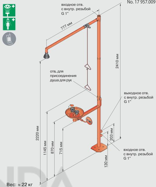
Душ для тела в комплекте с душем для глаз/лица и раковиной. Поставляется с самоосушающей головкой и химически стойким покрытием BROEN Polycoat. Материал – латунь или нержавеющая сталь. Душ для глаз содержит встроенный компонент FLOWFIX (26 л/мин). Раковина производится из нержавеющей стали и имеет при себе встроенное выпускное отверстие.
