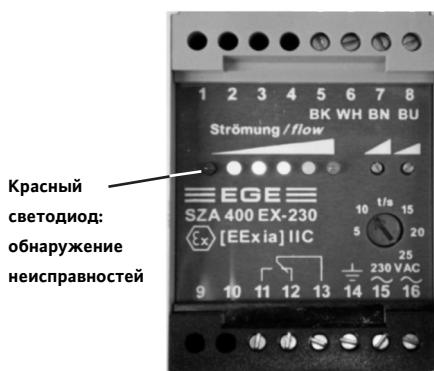
Отрегулируйте время задержки выключения с учетом неисправности и нужного значения. Если температура перекачиваемой жидкости выполните проверку безопасности. От номинального объемного расхода постепенно переходите к минимальному вплоть до нулевого объемного расхода. В конце настройки времени задержки выключения должен загореться красный светодиод, а электродвигатель насоса должен отключиться.
